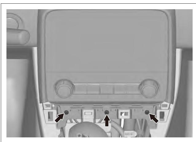
9. 断开线束接插件，取下中控面板开关总成
